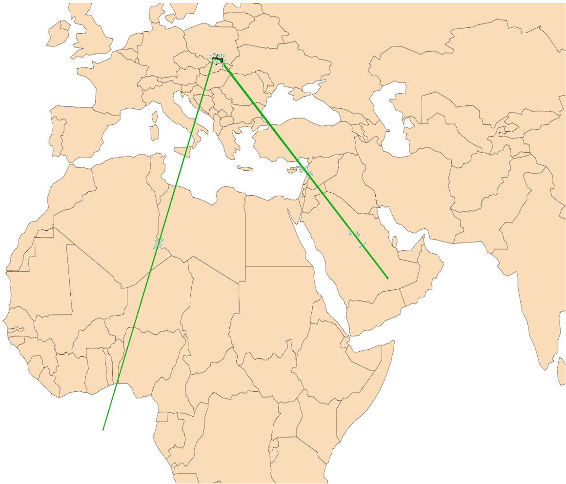
Rys 4. Błąd lokalizacji przystanków (współrzędne 0, 0 oraz zamienione miejscami) dla przykładowego GTFS. Podkład mapowy: naturalearthdata.com
